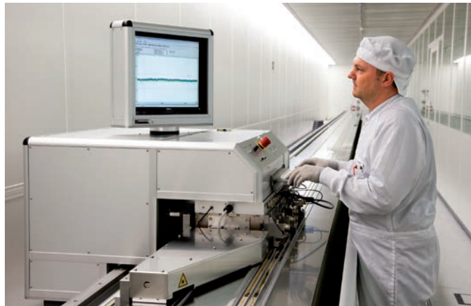
Machine de mesure de 30 mètres de long pour les rubans de mesure
