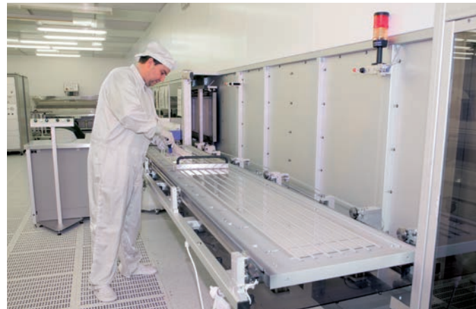
Installation sous vide pour la dépose des couches de chrome
