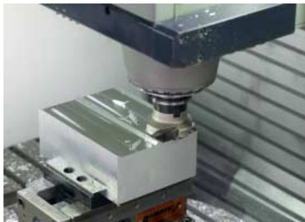
Potenza media assorbita degli azionamenti nella sgrossatura radiale Testa portataglianti: D = 60 mm, velocità: 4 100 giri/min, incremento in profondità: 4 mm
