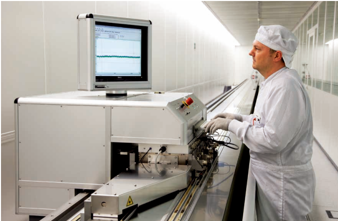
30 m长测量机应用的钢带光栅尺
